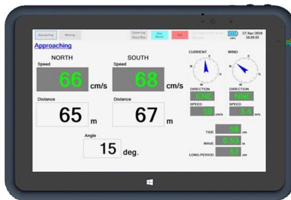
石油やLNG等の危険物取扱棧橋では、離着棧や係留状況を確認するため、各種気象海象情報や接岸速度・距離、係留索の荷重情報を監視しています。
